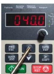
7. После того как выбран разряд для изменения при помощи кнопок «ВВЕРХ» / «ВНИЗ» вводим необходимое значение. Например, 40, если мы используем датчик давления 10 bar, регулятор будет поддерживать давление в системе водоснабжения 4 bar, если датчик на 16 bar то регулятор будет поддерживать давление 6,4 bar.
