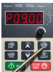
3. Затем нажимаем кнопку «ВВОД» (входим в 9-ю группу параметров), на дисплее отображается один из параметров группы, например P09.00 – источник задания ПИД-регулятора (P09-номер группы, 00-номер параметра)
