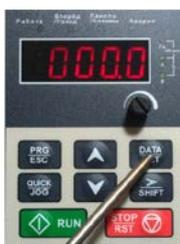
5. Нажимаем кнопку «ВВОД» (входим в параметр), видим на дисплее текущее значение параметра, например 000.0. Диапазон значений в данном параметре 000.0 – 100.0%. Если датчик давления подключенный к ПЧ имеет номинальный диапазон 0-10 bar, то значение 000.0 в параметре соответствует 0 bar, а значение 100.0 соответствует 10bar. Если датчик давления на 16 bar значение 100.0 соответствует 16 bar.
