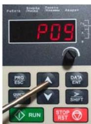
2. С помощью нажатий кнопок «ВВЕРХ» / «ВНИЗ» выставляем на дисплее значение P09 (группа параметров 9-настройки ПИД-регулятора)
