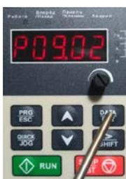
8. Далее необходимо записать (сохранить) заданное значение в память ПЧ, нажимаем кнопку «ДАТА», на дисплее отображается следующий параметр доступный для настройки. Если другие параметры менять не надо, выходим из программирования в основной режим (два раза нажимаем кнопку «ПРОГ»).
