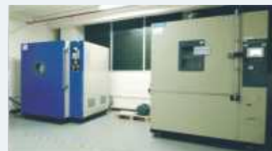
Камера испытаний на воздействие низкого давления (слева)
